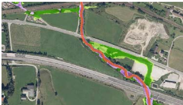
E1 und E2 - Fließgeschwindigkeiten HQ100 - betroffen E2
